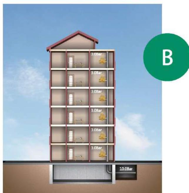
Para edificios de más de 5 plantas, la válvula reguladora de presión se debería de instalar en la acometida de cada vivienda o cada planta, con el fin de asegurar que todas las plantas tienen igual presión de entrada. Se aconseja también en este caso, instalar una válvula reguladora de presión de mayor tamaño en la acometida del edificio.
